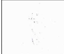
プリンター内に滞留したトナー粉末が、カートリッジ交換時等の振動で用紙搬送経路に落下して、トナー粉末をバラバラと落とした様な汚れが発生する場合があります。この場合は白紙の印刷を繰り返す事によりプリンター内部がクリーニングされて改善・解消されます。
