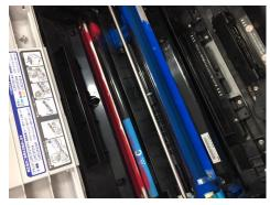
LP-S5300 に射光部に紙粉の汚れ及びトナーカートリッジ駆動部に 当機種特有のトナー飛散を確認。
