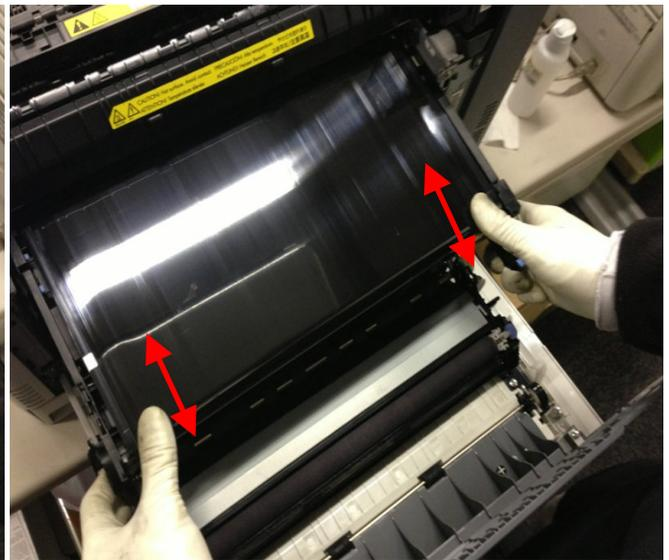
転写ベルトの両端を写真のように持ち親指で上下させます。
